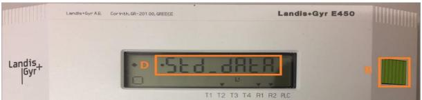
Mittels der grünen Taste (B) so viele Male, bis auf der Anzeige (D) «Std\_dAtA» erscheint. Anschliessend drücken Sie die grünen Taste (B) drei Sekunden, bis auf der Anzeige (D) «Std\_dAtA» wieder verschwindet.
