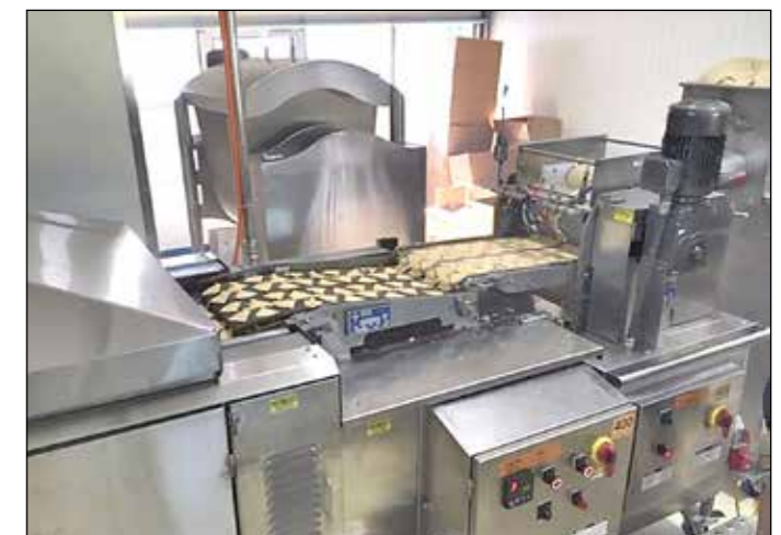
Die Chips werden aus dem Teig gestanzt.
