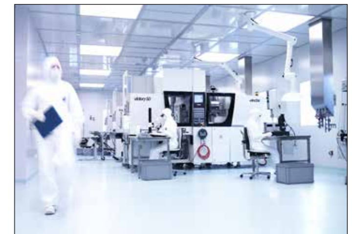
In den mit spezieller Partikelfilterung belüfteten Reinräumen sind nur effektiv arbeitsrelevante Gegenstände untergebracht.
