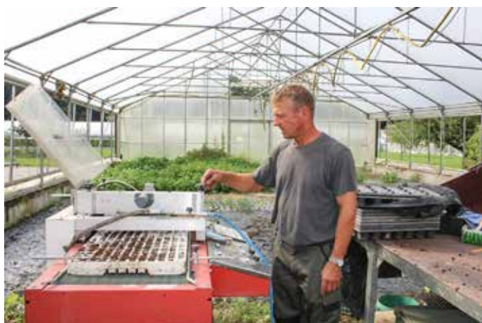
Peter Thurnheer zeigt uns die Setz-Maschine, welche das Saatgut zielgenau im Setzkasten in eine Vertiefung in der Erde platziert.
