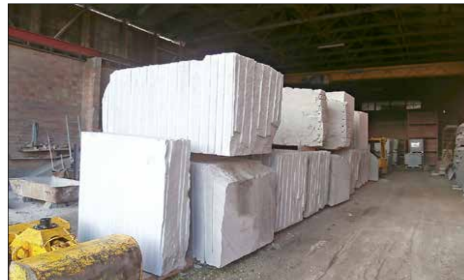
Die fertigen Blöcke. Gut zu sehen die zum Abbau gebohrten Löcher.
